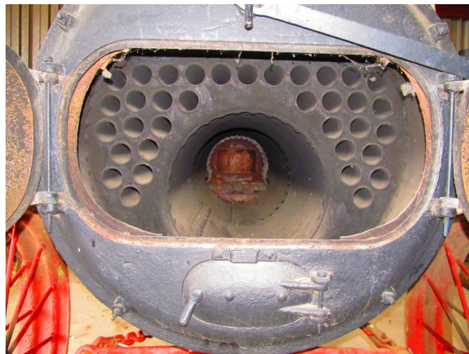
Fig. 3 Return flue boiler.
